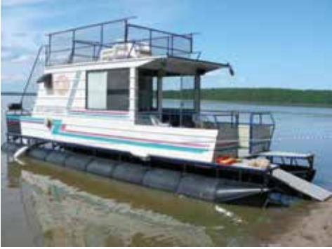
Şekil 2. Silindirik sephiye elemanlı HDPE ponton tekne [2]
