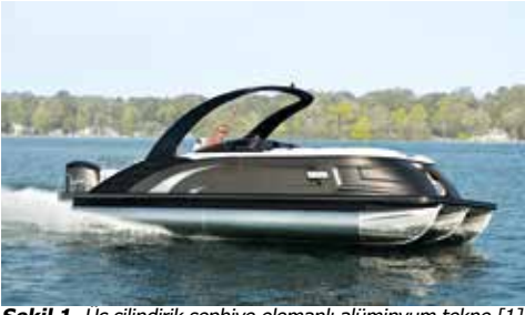
Şekil 1. Uç silindirik sephiye elemanlı alüminyum tekne [1]
