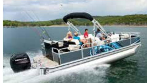
Şekil 6. Üç sephiye elemanlı dıştan takma motorlu performans teknesi [10]
